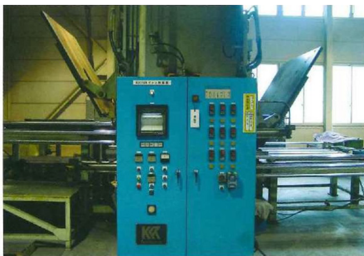
700トン2段プレス加流成型機 熱盤1500×1500mm大型プレス
